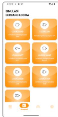
Gambar 3. 8 Tampilan Simulasi Gerbang Logika
